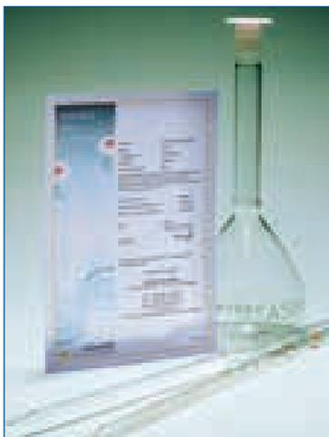
Les fioles, les pipettes, les éprouvettes et les burettes volumétriques Pyrex® et MBL® de Classe A/AS portent un numéro de série individuel et sont fournies avec un certificat de calibration individuel. Chaque certificat indique le volume réel, l'estimation de l'incertitude de mesure et la tolérance requise pour la conformité.
