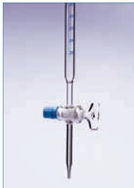
**i** BRB050P est munie d'un sommet avec forme entonnoir pour faciliter le remplissage. Les clés de rechange SSD102K sont disponibles à la page 263.
