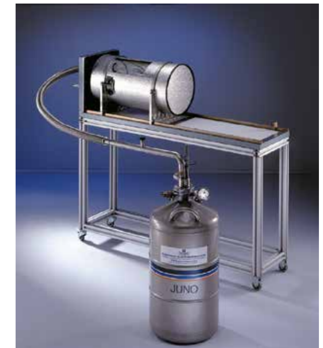
KALTGAS-System Typ TGK-40/50 für einen Temperaturbereich von +80^{\circ}\text{C} bis -160^{\circ}\text{C} , mit einer Temperaturstabilität bis \pm 0,2^{\circ}\text{C} . Die Kammer besitzt ein großes Sichtfenster.
