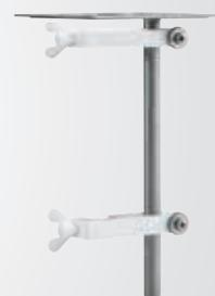
Support de tube viscosimétrique
